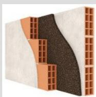
PAREDES DUPLAS EM TIJOLO CERÂMICO COM CAIXA DE AR E ISOLAMENTO TÉRMICO.
